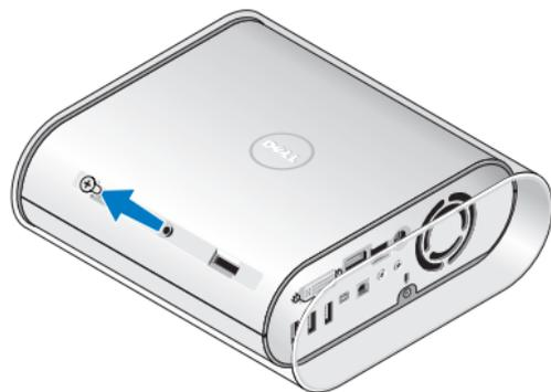
2. Coloque el ordenador verticalmente y tire del protector suavemente hacia la parte posterior del ordenador. A continuación, deslice el nuevo protector sobre el ordenador.
