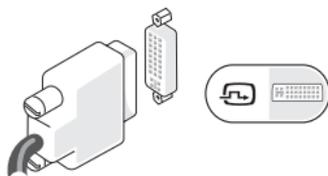
Conecte la pantalla mediante un cable DVI (suele tener conectores blancos en ambos extremos).
