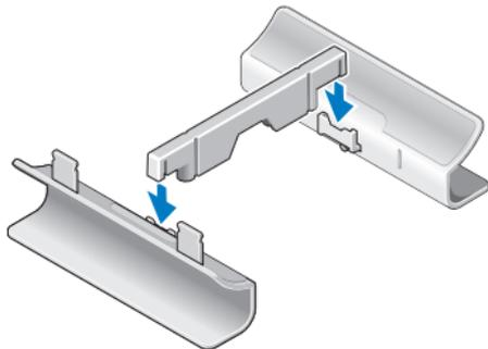
Alinee las lengüetas de fijación de la base con las ranuras del ordenador y coloque este último sobre la base hasta que las lengüetas se inserten completamente en las ranuras.
