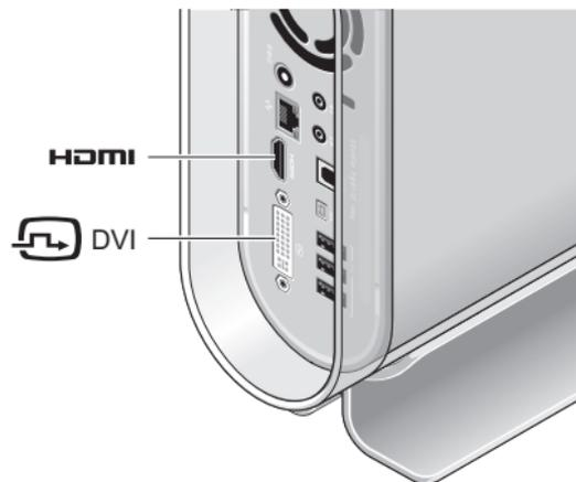
Conecte la pantalla utilizando **SOLAMENTE UNO** de los siguientes conectores: el conector DVI blanco o el conector HDMI.
